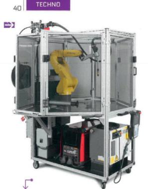
Le robot dispose d'un équipement dédié au soudage qui comprend notamment, un générateur de courant de forte puissance, un dévidoir pour le fil d'apport et bien sûr, la torche.
